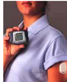
Figura 3.4 - Protótipo de sensor contínuo de glicose (Therasense Inc.).
